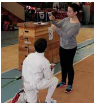
Prüfung der Degenspitze und des Auslösekontaktes mit dem Prüfungsgewicht durch Andreaa Poppa, TV Wetzlar
